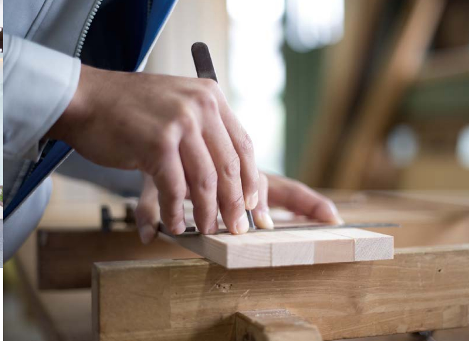
日本の建具には、日本独自の木造建築の技術が用いられている。写真は木材を加工する目印をつける「墨付け」という作業。機械による一律の作業では見落としてしまうような木のねじれや節といったものも、手作業で仕上げることでしっかりと見極めながら加工していく。職人の手の感覚でしか成しえない技術。これもバンクラの得意とするところだ
